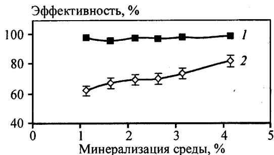
Рис. 2. Эффективность удаления сульфата и ацетата (квазистационарные данные) при повышении минерализации среды в лабораторном UASB-реакторе
