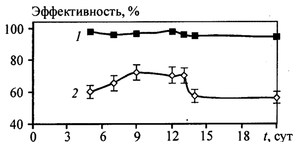
Рис. 1. Эффективность удаления сульфата и ацетата при запуске лабораторного UASB-реактора
